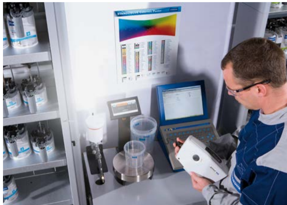
Moderní míchárna se dnes již neobejde bez elektronického softwaru pro určování receptur, pokročilých fotospektrometrů a elektronických vah, na které jsou přenášena získaná data pro požadovaný odstín a množství barvy.
