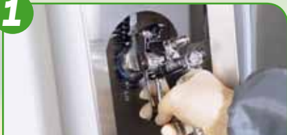
Čištění barvého kanálku a vzduchové trysky
