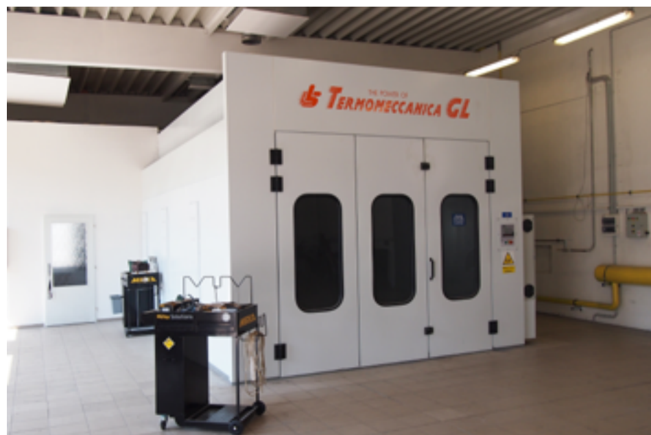
Nejnovější verze lakovací a sušící kabiny Termomeccanica Powertherm, která využívá technologie přímého ohřevu a frekvenčních měničů. Ty stojí za úsporou až 30 % provozních nákladů. Ovládána dotykovým displejem v češtině.
