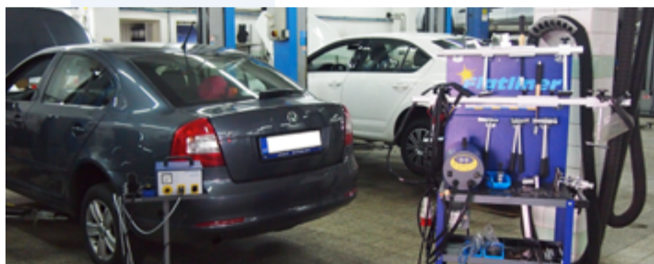
Systém Flatliner od švýcarské společnosti Betag pro opravu drobných a středních karosářských poškození.
