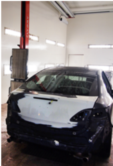
Sušiči robot Symach Flydry umístěný v lakovacím a sušícím boxu, s nejvyšší možností instalace o výšce zavěšení 4 metry, která umožňuje i sušení dodávek a nákladních vozů.
