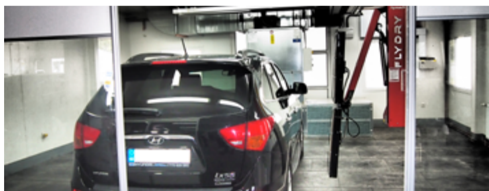
Přípravné stání se stěnovým odsáváním s možností drobných lakovacích prací, které je vybaveno sušícím robotem Symach Flydry.
